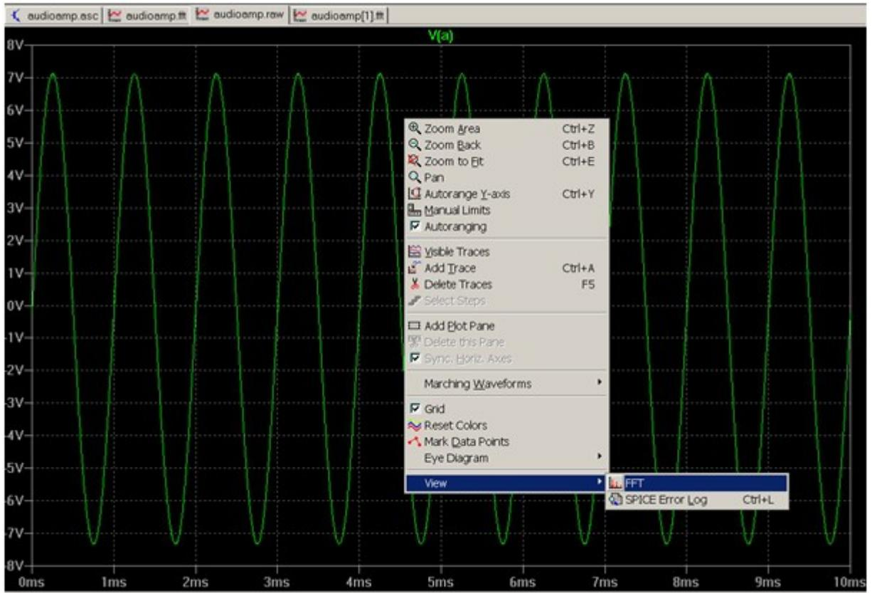
瞬态分析的精度靠的是时间间隔设置，实际上就是采样精度，取去多少个点计算，比如进行FFT分析，如果点数太少，分析出来的数据就不准确，但是并不是说点数（精度）越多越好，当达到一定程度，精度足够高的时候，已经没有多大的区别，这样增加精度只是增加计算时间而已（1us 和 1ns 相差 1000 倍的计算时间）。
