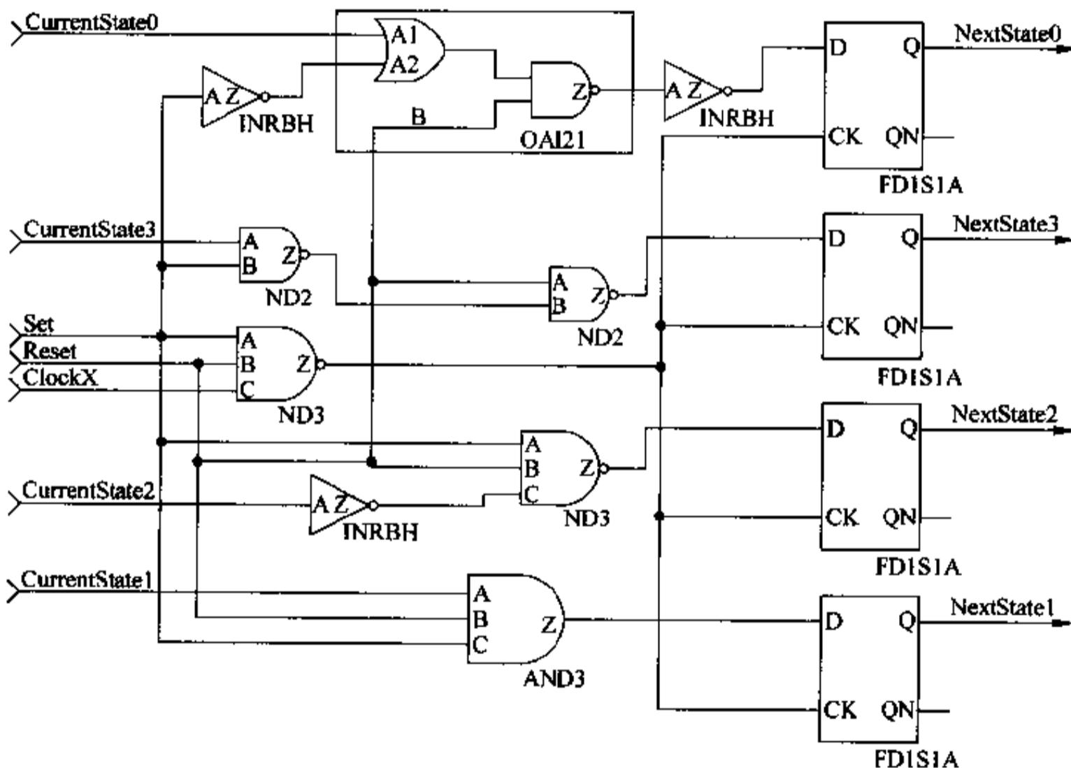
图 2-43 无异步预置位和清零的锁存器
