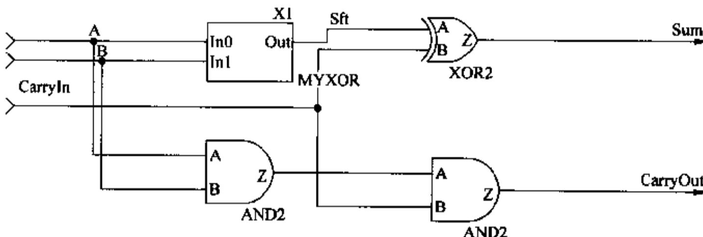
图 2-67 混合使用模块实例和行为表示
