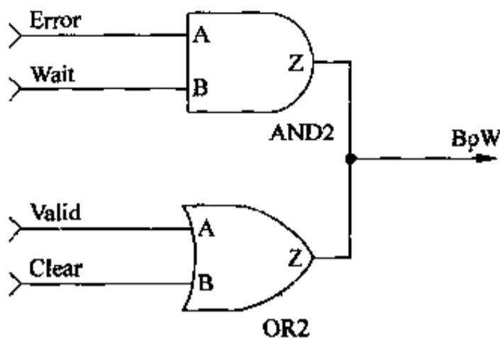
图 1-6 多个驱动源驱动同一根 wire 网线
