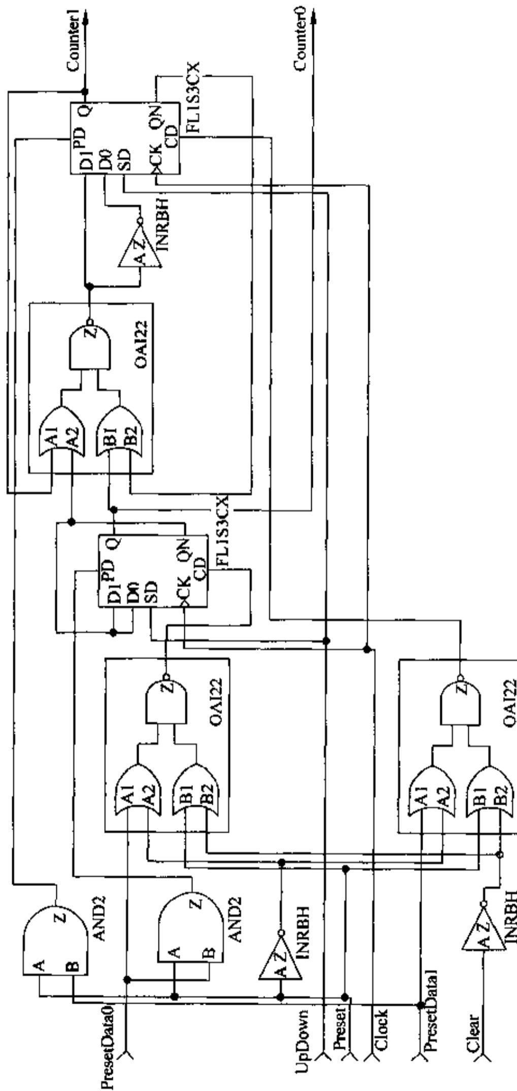
图 2.52 带异步预置位和清零的触发器
