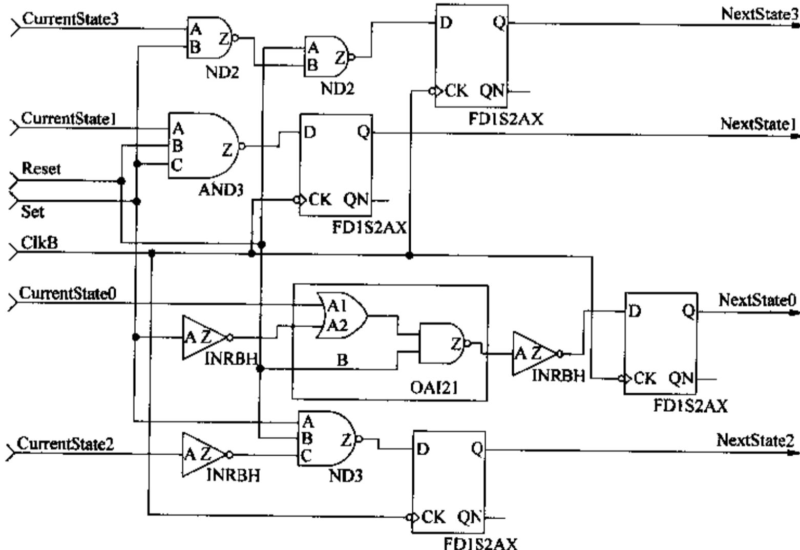
图 2-55 并非带同步预置位和清零的触发器
