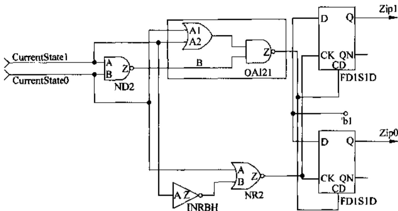
图 2-33 case 语句内的变量被推导成锁存器
