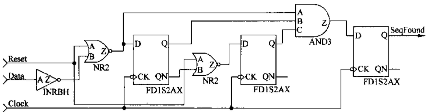
图 3-27 统计出现连续 3 个“1”的电路
