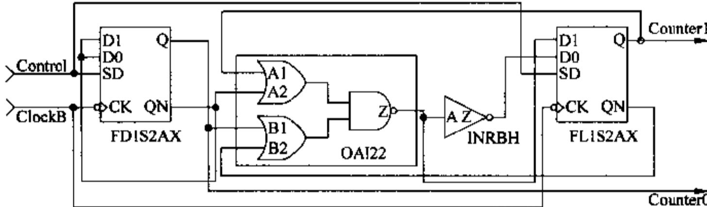
图 2-47 推导出下降沿触发的触发器
