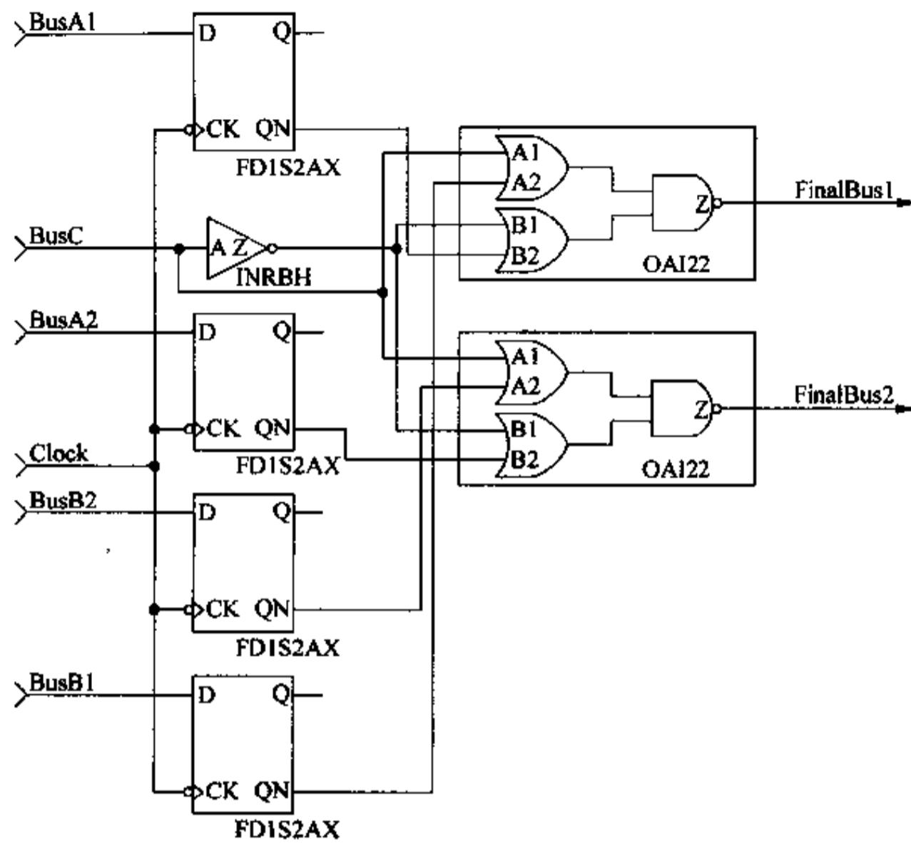
图 2-72 实例化一个参数化的寄存器
