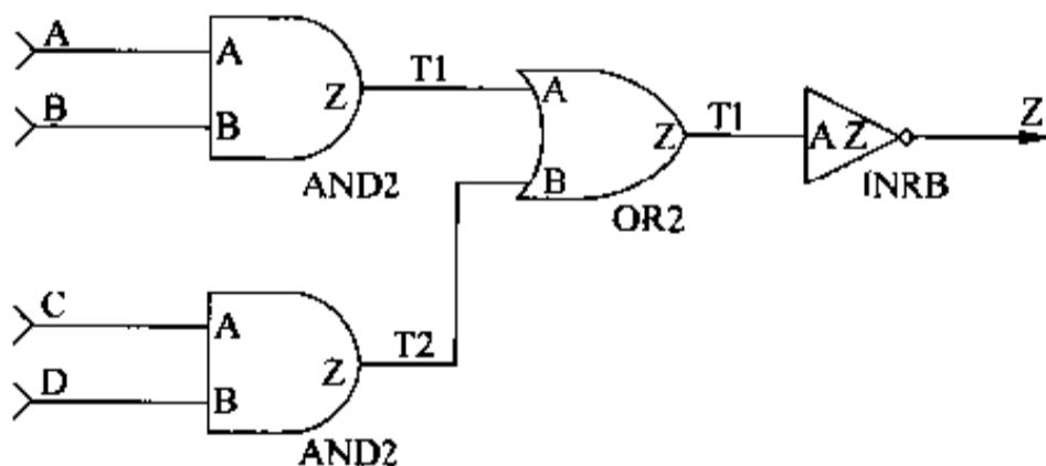
图 2-22 一个变量能表示多根连线
