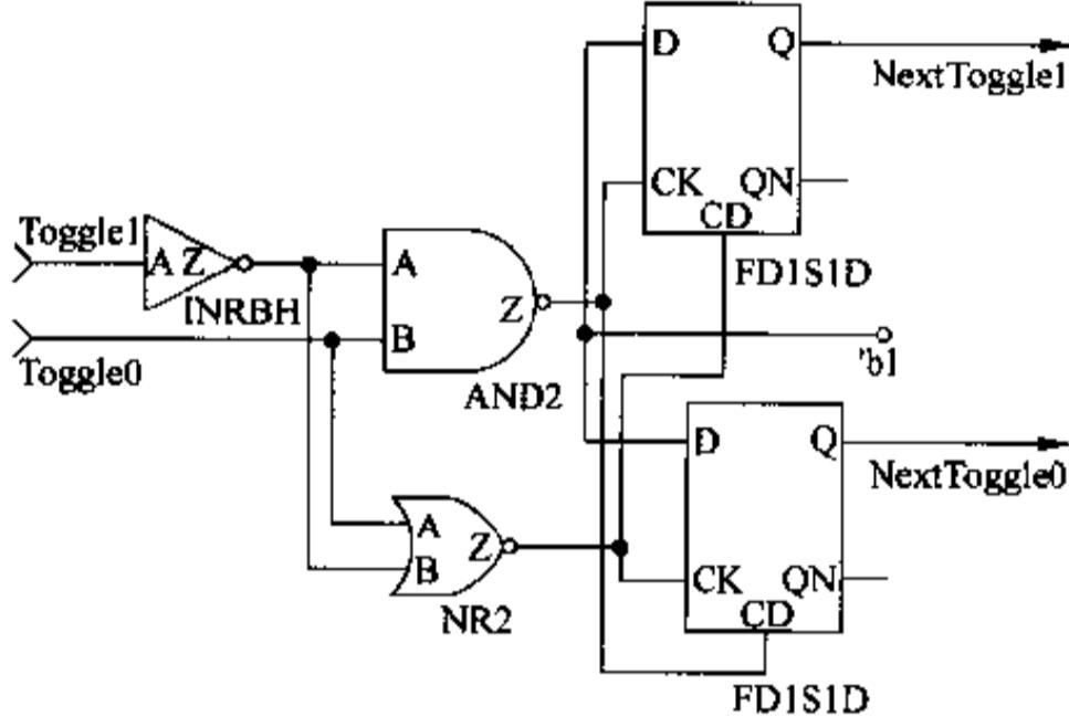
图 2-34 NextToggle 被推导成锁存器
