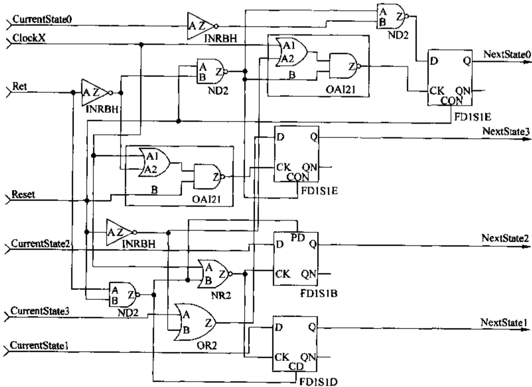
图 2-42 带异步预置位和清零的锁存器
