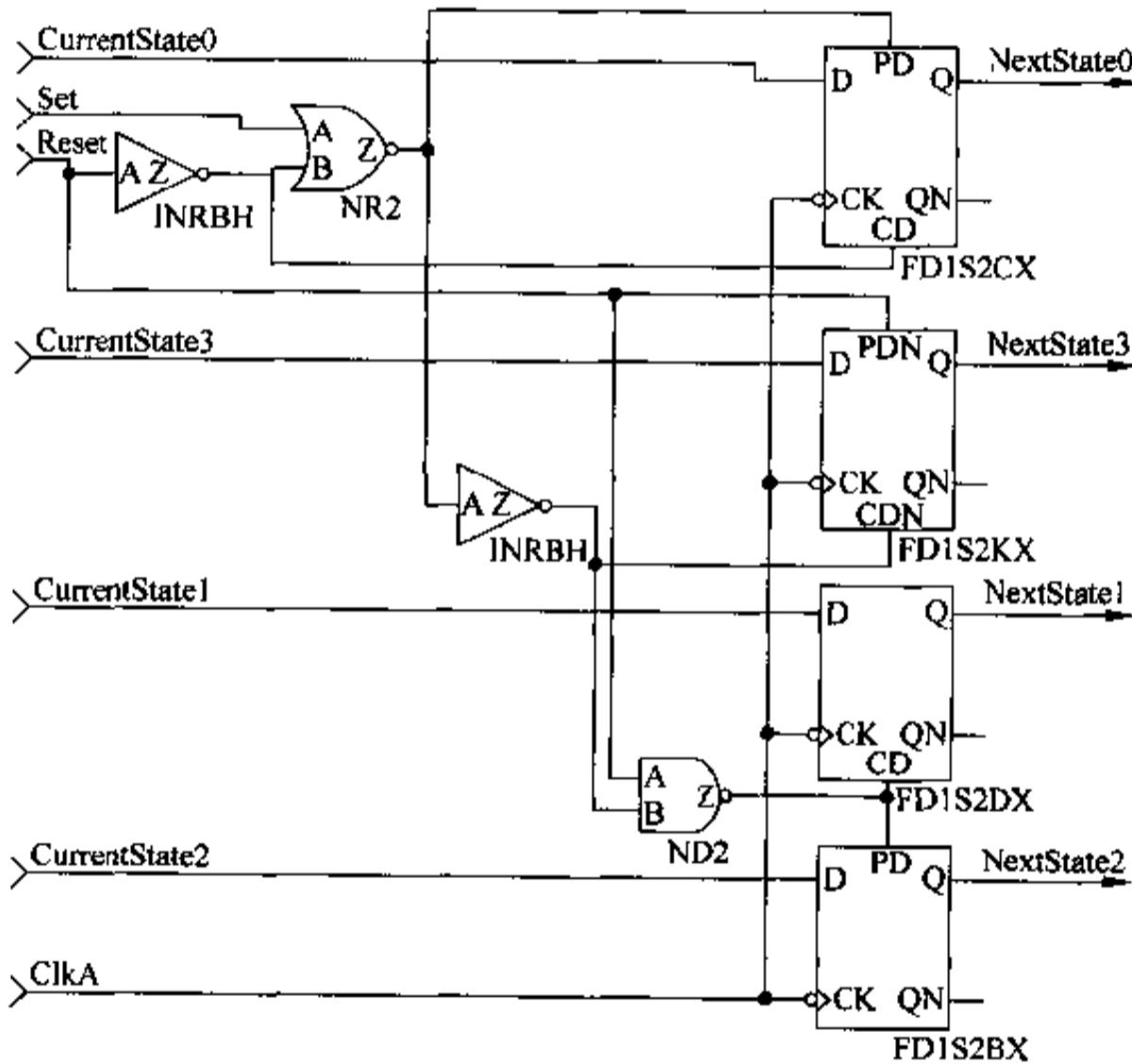
图 2-53 带异步预置位和清零的触发器
