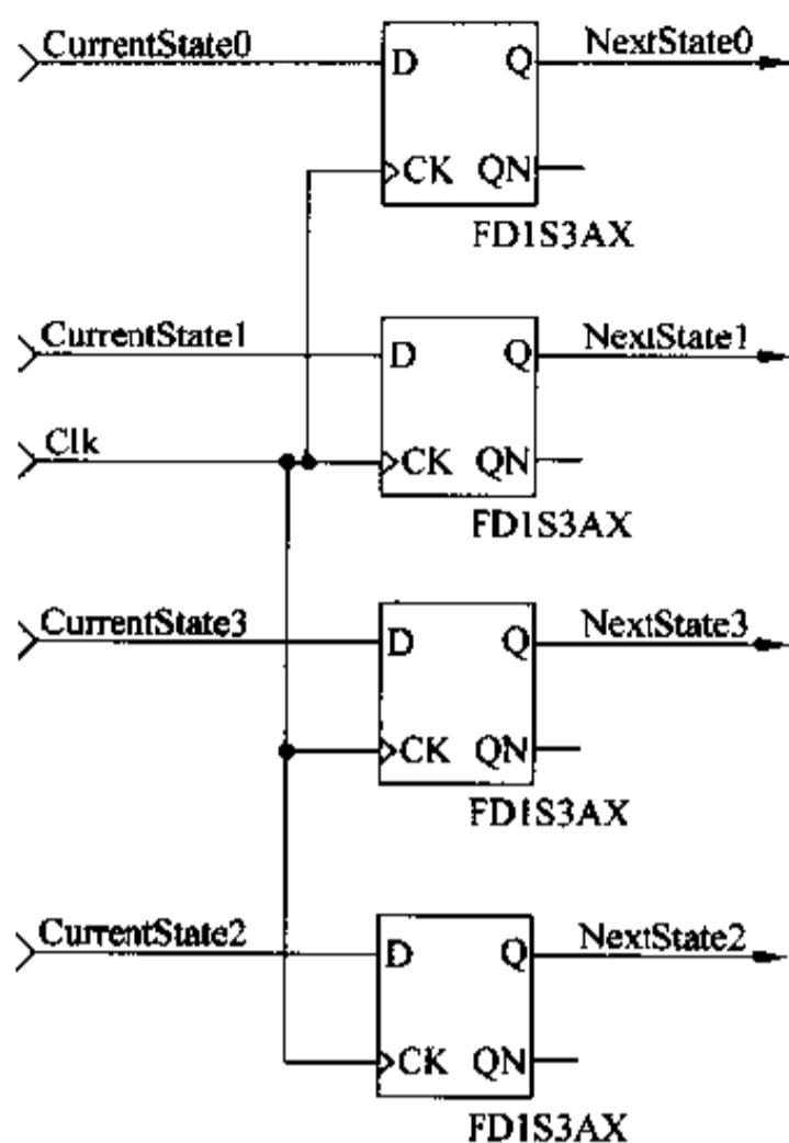
图 2-48 时钟控制下的变量被推导成触发器
