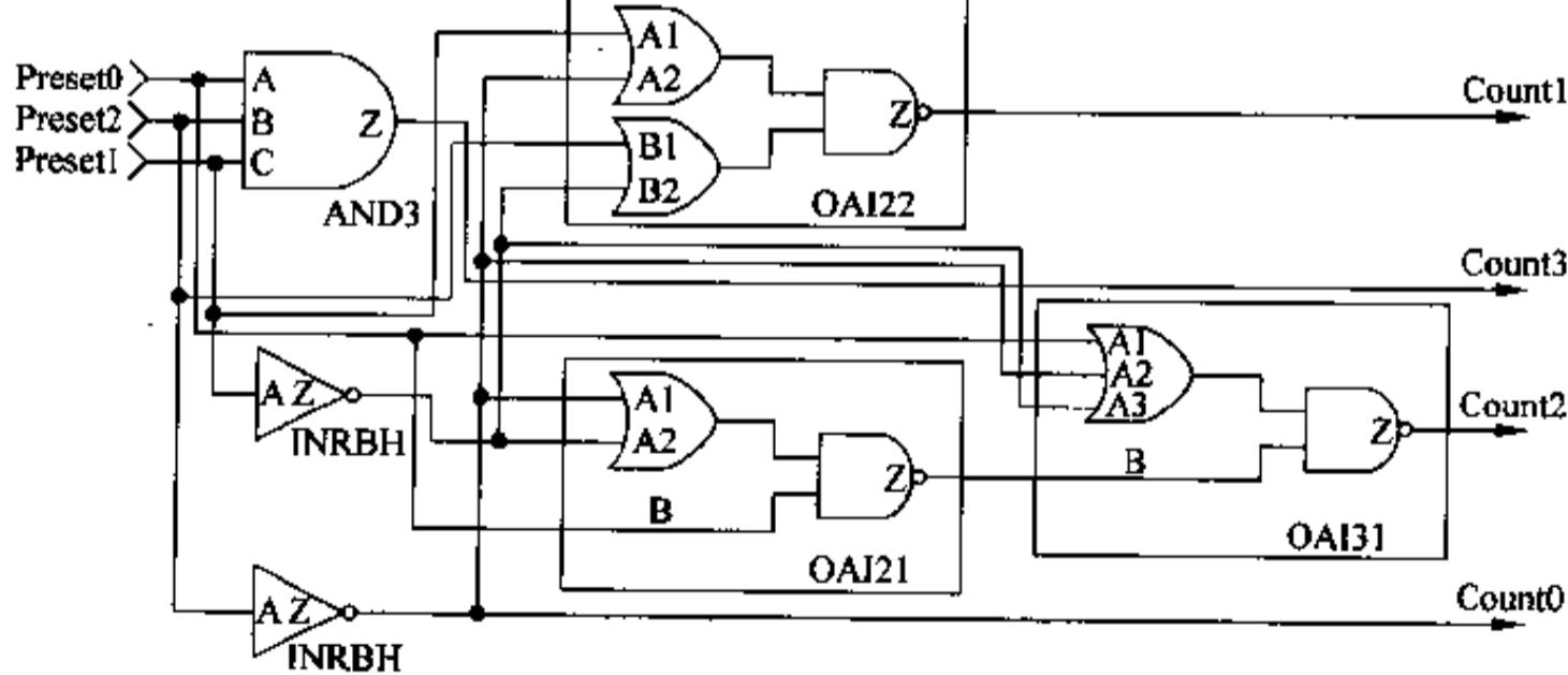
图 2-2 由阻塞式过程赋值得到的组合逻辑电路
