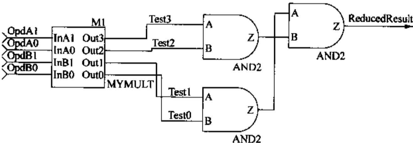
图 2-68 实例化预定义的乘法器
