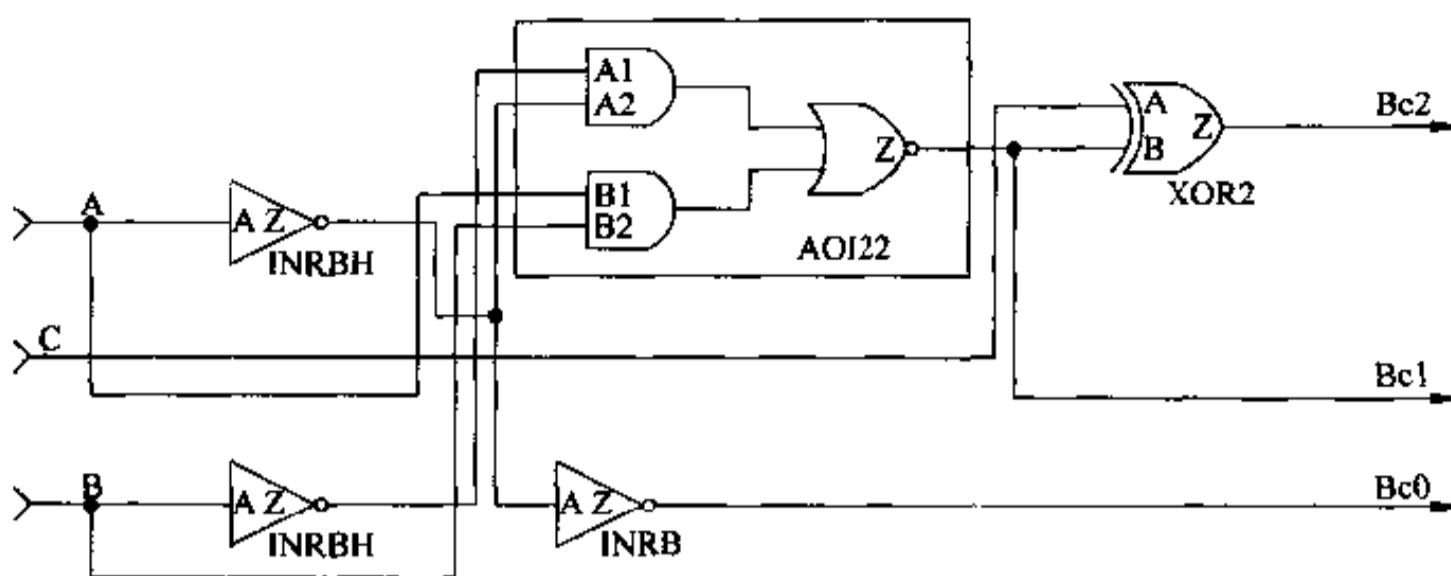
图 3-4 格雷码至二进制编码转换的逻辑电路
