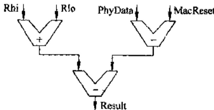
图 4-5 使用括号后综合出的电路
