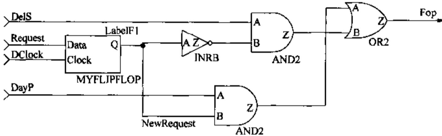
图 2-69 实例化预定义的触发器
