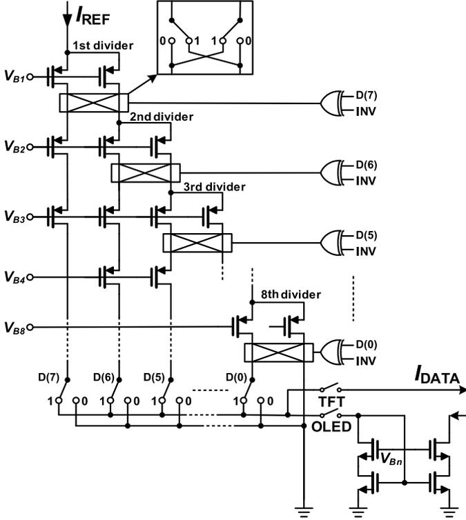
Fig. 10. Bit-inversion cascade-dividing CDAC (BICCDAC).
