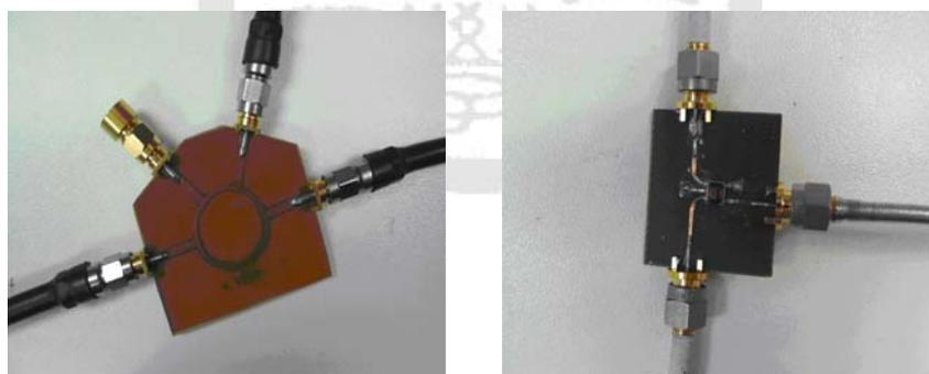
圖 3.26 混頻器量測時所採用的 ring 及 transformer(mini-circuit TC1-1T)
