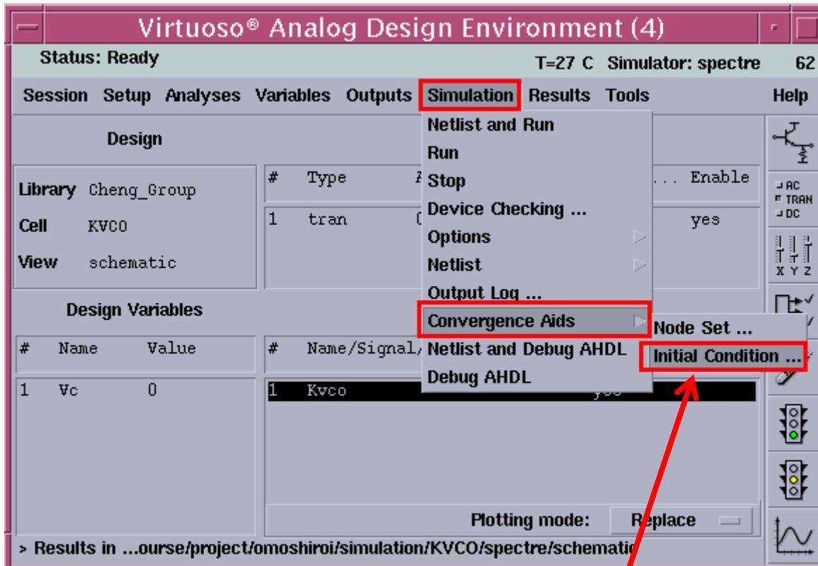
對於一個震盪器的模擬，一定要設定Initial Condition，點選 Simulation -> Convergence Aids -> Initial Condition
