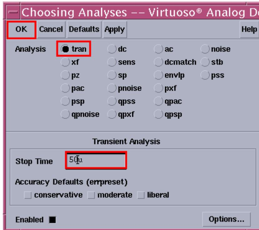
在模擬選擇上，選tran，然後在stop設定要觀看的時間，設定完後點選Enabled，然後點OK結束，設定完成後，可以先將要看的位置用Outputs裡面的設定(不是這個視窗)先選好，再跑模擬
