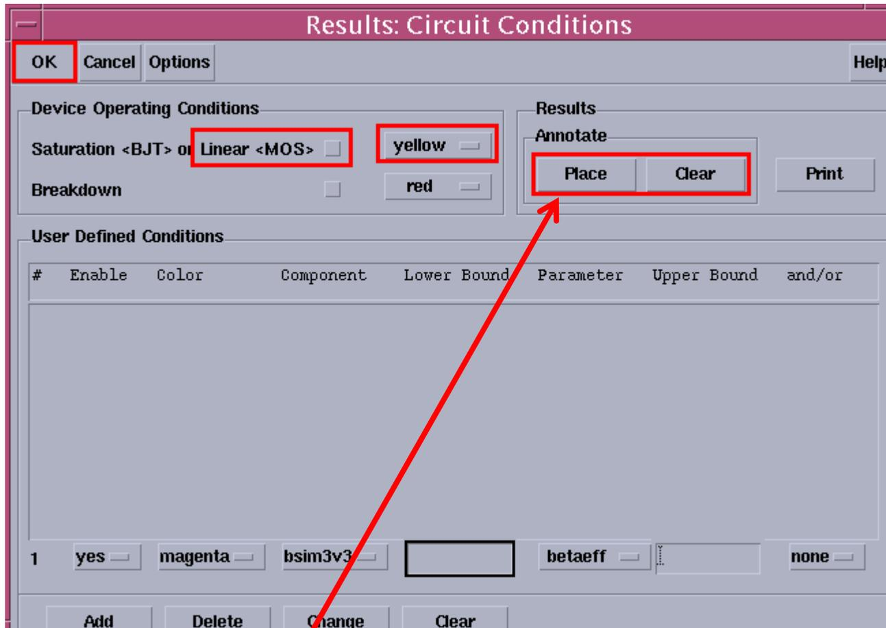
在Circuit Conditions的視窗裡，勾選Linear <MOS>，選想要標記的顏色，然後點選Place，就會在電路圖將位於線性區的MOS給框起來，再設計類比電路時非常好用，點選Clear可以清除框起來的元件
