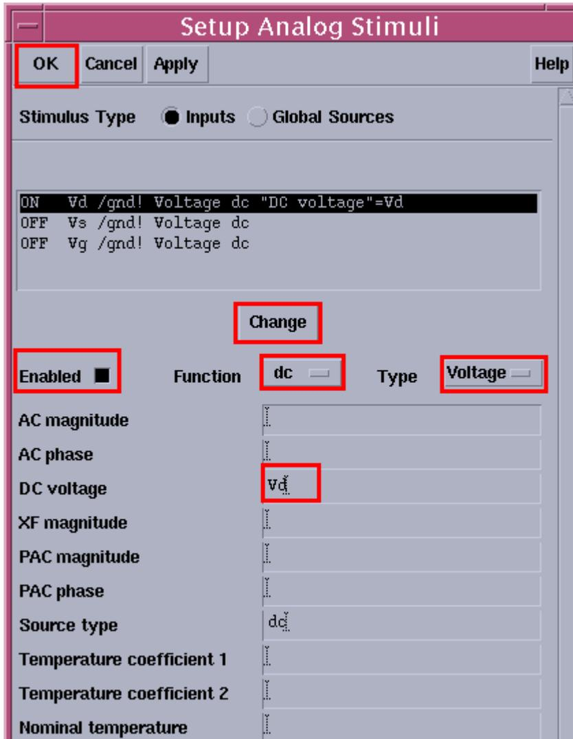
在設定視窗中，先點選欲設定的 Pin，然後勾選 Enable，選擇 Function，然後再選擇 Type，之後再到下面的欄位輸入需要的資訊，在此為設定 DC 電壓源，在 DC voltage 的欄位中，可以輸入數字或是變數名稱(在此輸入變數名稱 Vd)，設定完後，要點選 Change，然後用同樣的方式設定其他的 input Pin，全部設定完後，點選 OK
