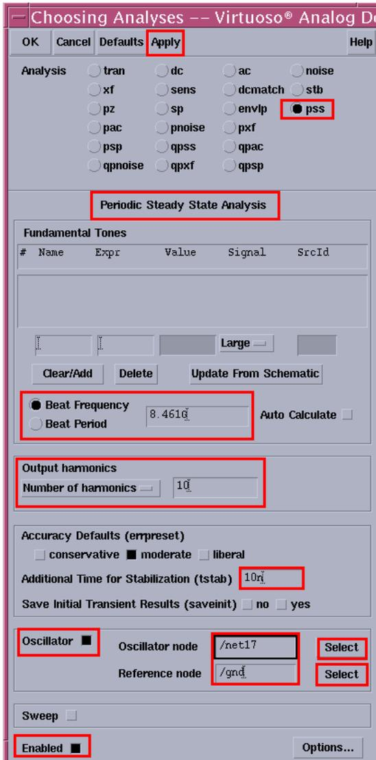
模擬先選擇pss，然後點選Beat Frequency，輸入剛剛所得的中心頻率，在Number of harmonics中輸入10，Accuracy Defaults選擇moderate，Additional Time for Stabilization中輸入電路需要多少額外的時間穩定，然後勾選Oscillator，Oscillator node用旁邊的Select鍵在電路圖上面選擇輸出點，Reference node用同樣的方式選擇接地點，最後勾選Enabled -> Apply (還有其他模擬要設定)
