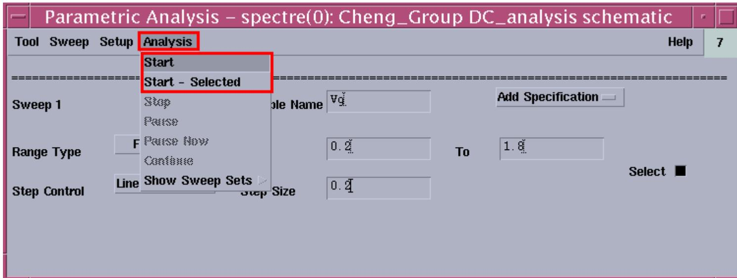
以上設定為Variable Name輸入Vg，From 0.2 To 1.8，Step Control裡設定為Linear Step，Step Size為0.2，設定完後，點選Analysis -> Start或是Start Select
