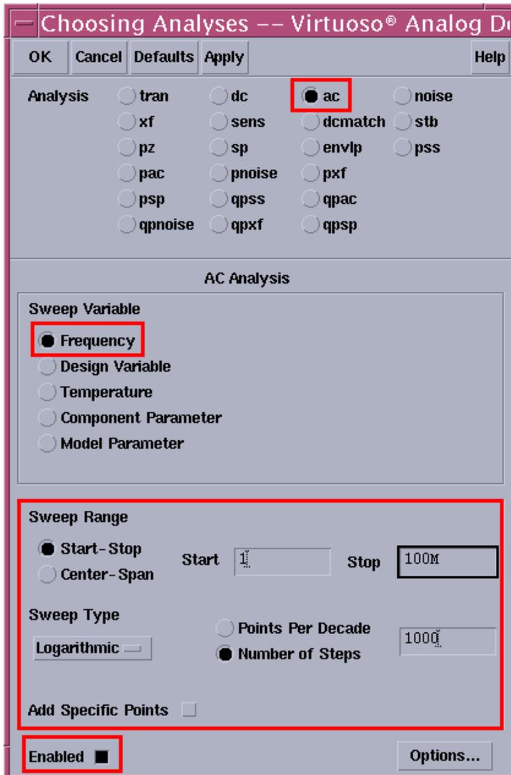
模擬選擇ac，在Sweep Variable上面選擇Frequency，範圍從1掃到100M(可以依需求來改)，Sweep Type選擇Logarithmic，總共掃1000點，然後點選Enabled，在點選OK，設定完後，就可以點開始模擬
