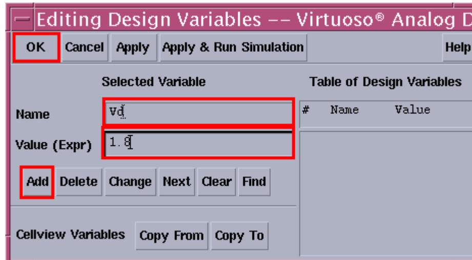
設定變數的方式，首先在Name的欄位裡面，輸入變數名稱，然後在Value裡面輸入數值，完後點選Add，再以同樣的方式定義其他變數，結束點選OK
