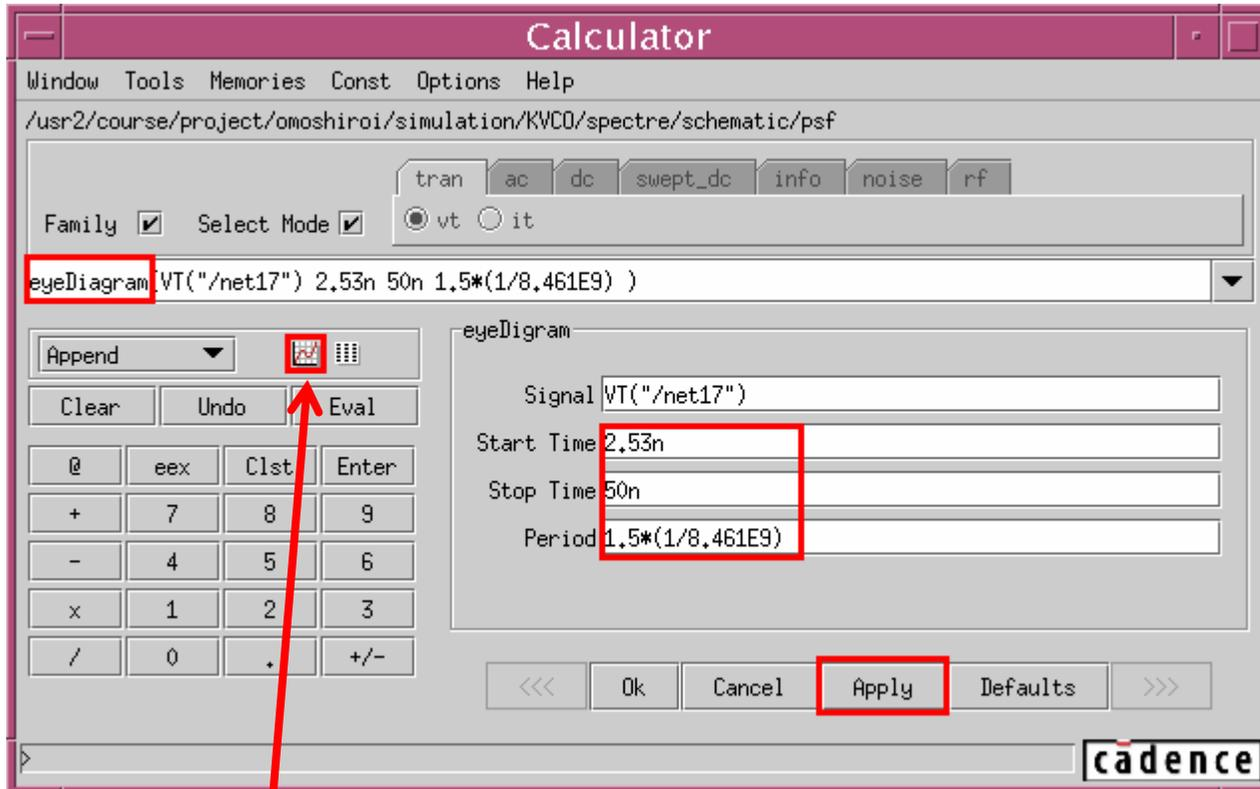
在Calculator視窗，先到上欄位的tran點vt，然後在選擇輸出點，之後再到function裡面點選eyeDiagram，然後輸入剛剛得到的起始時間，以及想要的終止時間，最後在Period輸入 $1.5*(1/f)$ ，f為頻率，輸入完後點Apply，在點此鍵，就會跑出眼圖
