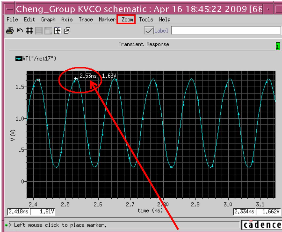
從輸出波形中，選擇一點最高點的時間當作眼圖設定起始時間
