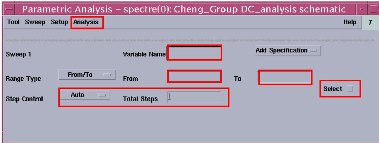
在Parametric Analysis視窗中，Variable Name輸入其他的變數(不同於dc Sweep裡面的設定)，設定方法，跟設定dc sweep一樣，然後在勾選Select
