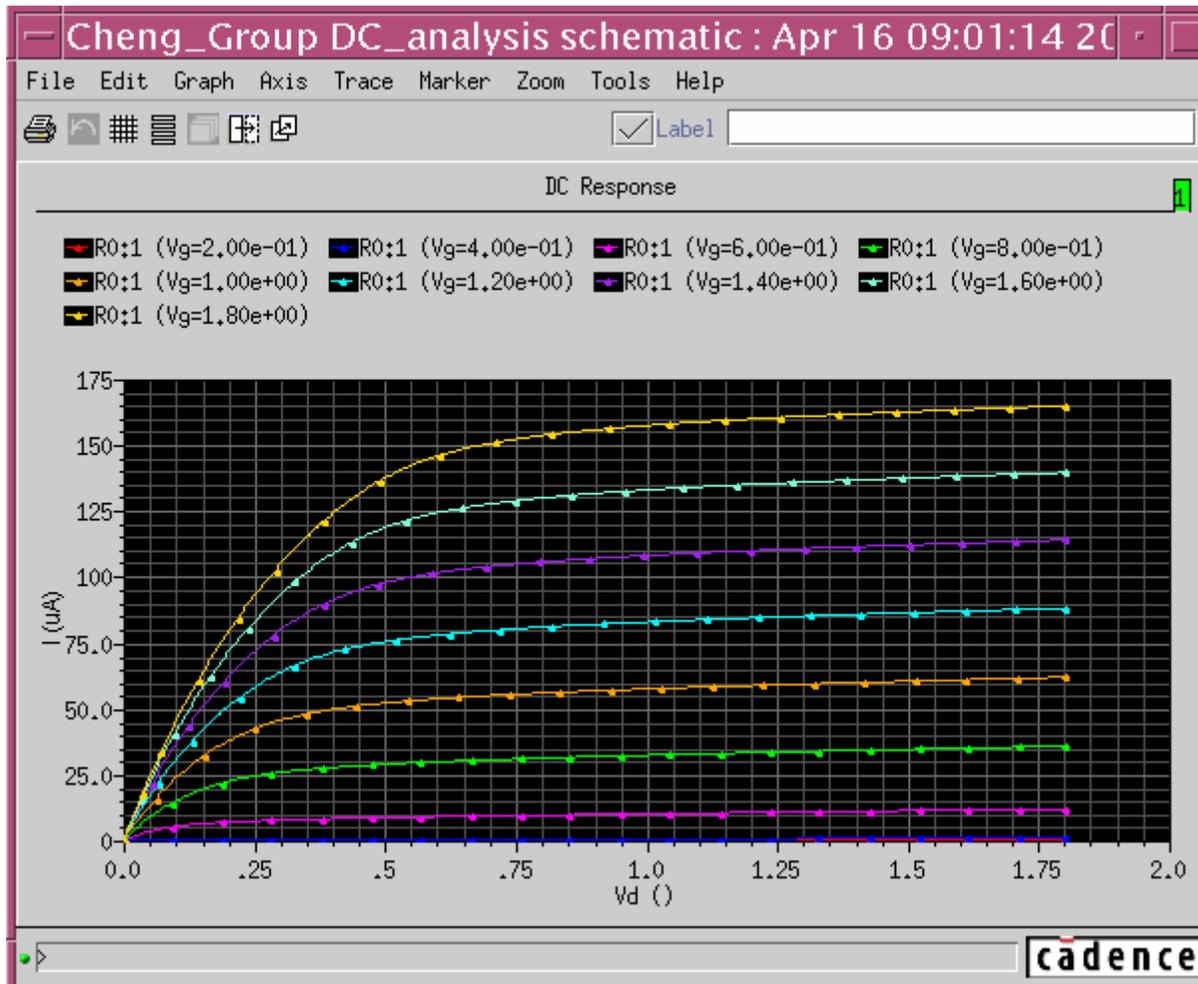
模擬結果會如上圖，不同的 $V_{gs}$ 下的 $I_d$  curve
