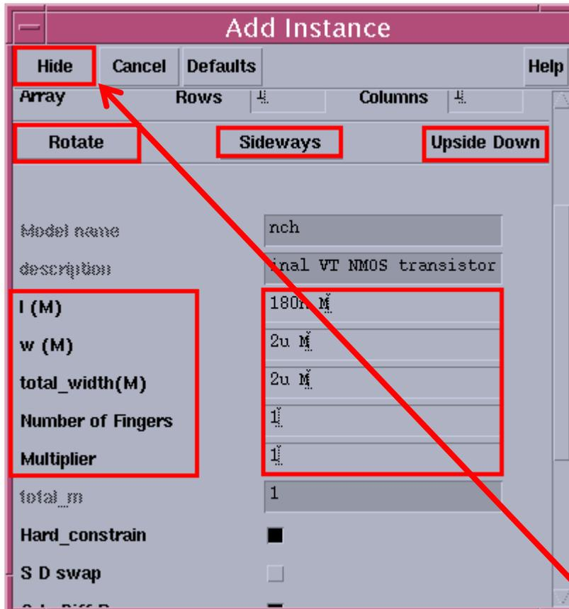
之後回到視窗Add Instance，Rotate可以順時針旋轉物件，Sideways可以左右鏡射物件，Upside Down可以上下鏡射物件
