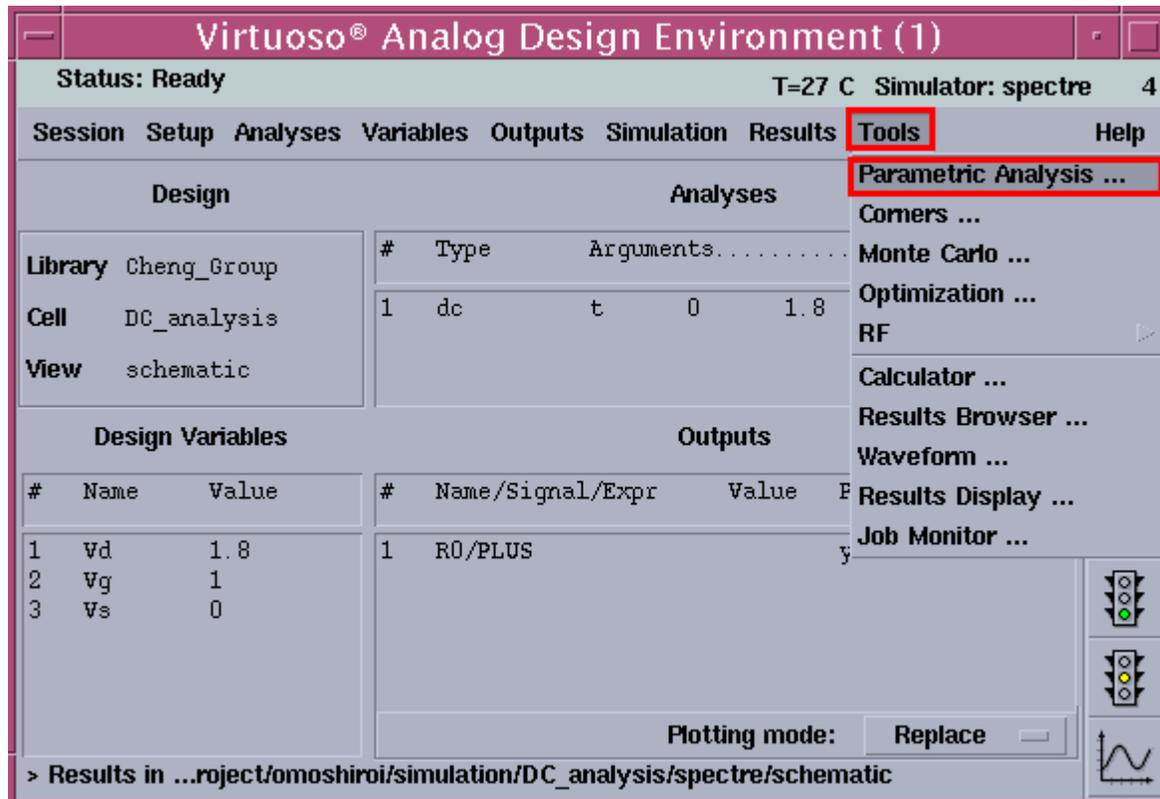
在 Tools-> Parametric Analysis 選項裡，可以在現在模擬的設定下，改變其他的變數做同一件模擬，在此是以改變  $V_{gs}$  的電壓，來觀看不同的  $I_d$  曲線
