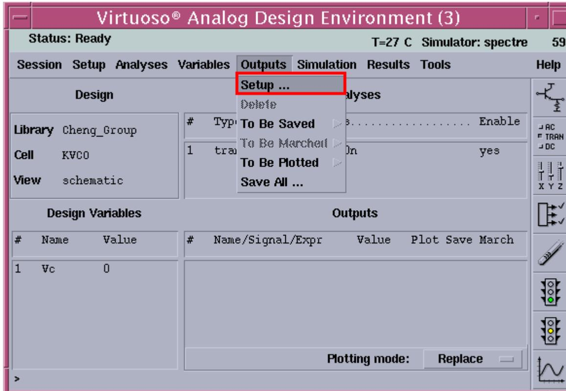
將Vc設為變數，Vdd及gnd都設定好後，分析選擇tran，接著從Outputs -> Setup設定想要看的結果
