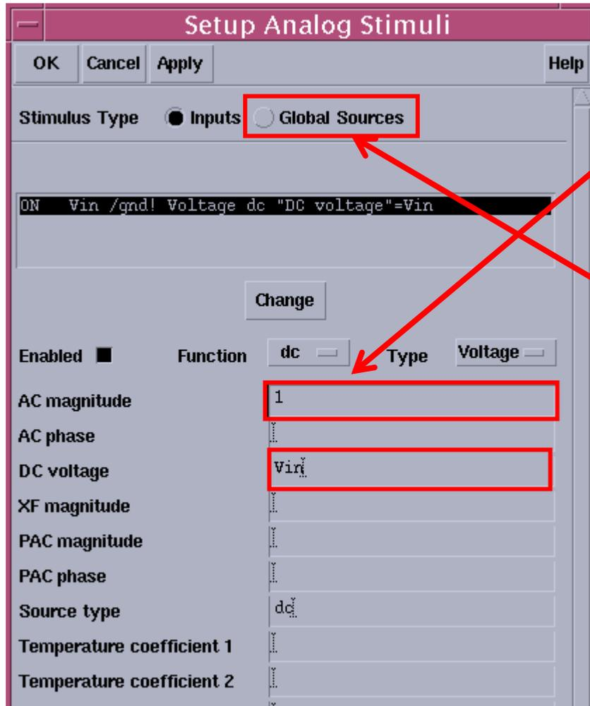
Pin的設定上，AC magnitude要設定1(小訊號)，Vin的部分，可以設為0(若有offset的部分，則可以輸入offset電壓)
