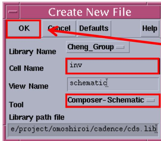
在Cell Name欄位上面，輸入電路名字(此為inv)，Tool欄位為下拉式選單，選擇Composer - Schematic，然後點OK
