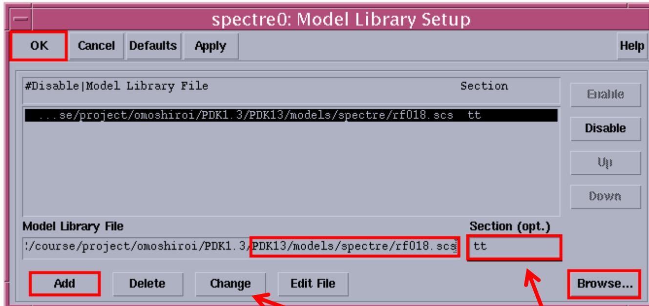
在設定視窗中，先點選Browse來找尋Spice model，spectre專用的model放在PDK資料夾裡面的/PDK13/models/spectre/rf018.scs，找到之後，就會出現在Model Library File的欄位裡，然後在旁邊Section (opt.)的欄位打上tt也就是TT corner，之後點選Add，加入成功後，點選OK離開
