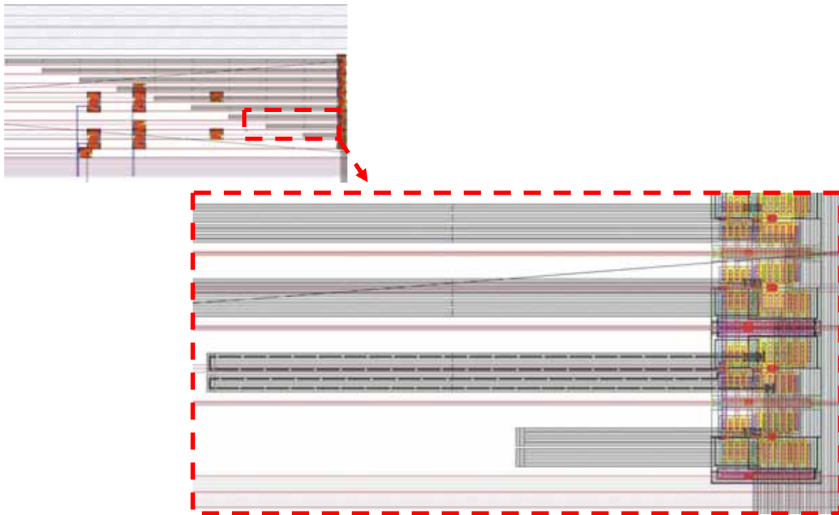
圖 3.62 時脈訊號繞線佈局圖
