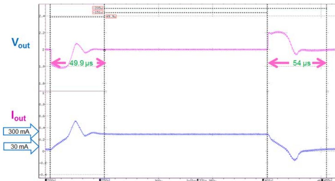
圖 4-4 當負載變化時輸出電壓之變化模擬圖 (3.6V to 2V)
