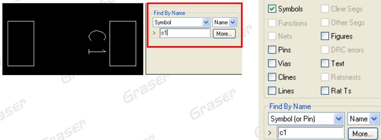
4. 當零件數量很多，板框周邊空間有限時，就會出現無法對零件進行快速擺放的動作。現在我們可以通過 Quickplace Overlap controls 功能，將同類零件進行重疊處理來實現 quickplace。
