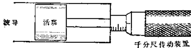
图 6.2 一种简单的波导短路器
