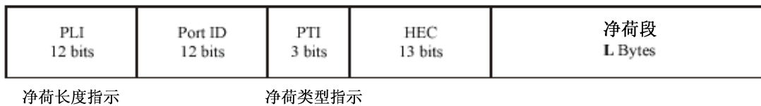
图A.1 GEM帧中的TDM数据帧结构
