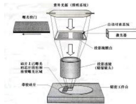
图 2.11—光刻机结构原理示意图
